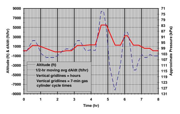
FIGURE 11. PRESSURE-TIME ENVIRONMENTAL TEST CYCLE
