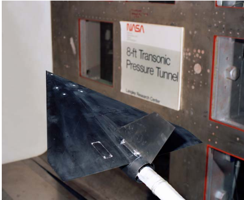
(d) Wing-alone configuration with centerline tail
