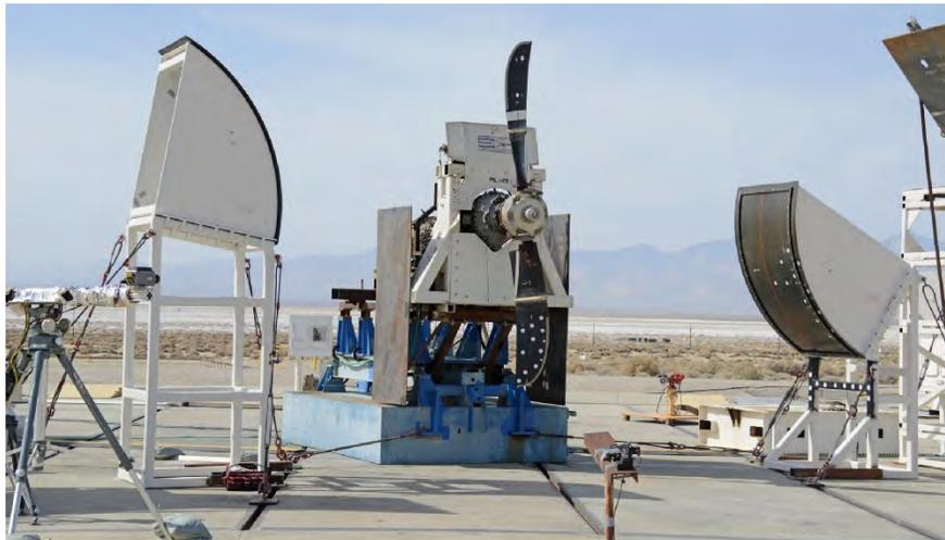
Figure 11.—Open-rotor fan blade-off test rig.
