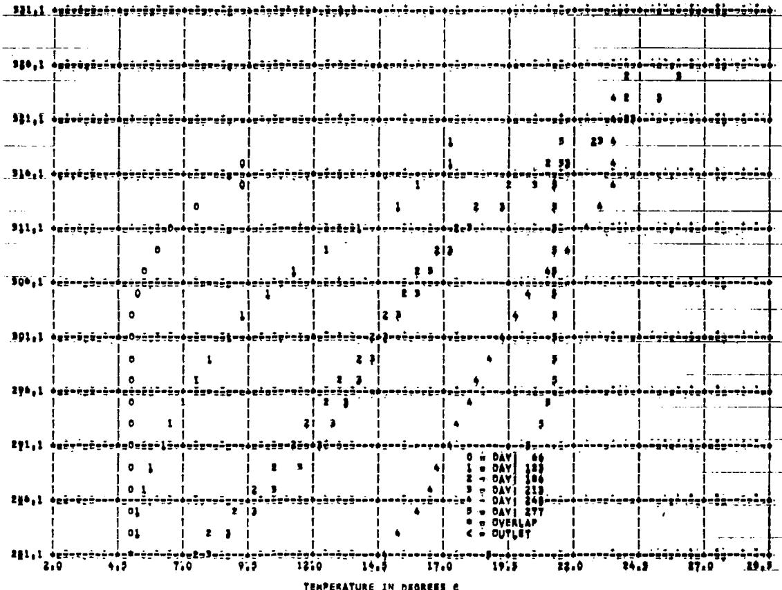
Figure 69 MIT MODEL • CHEROKEE RESERVOIR 1967 COMPUTED TEMPERATURE PROFILE
