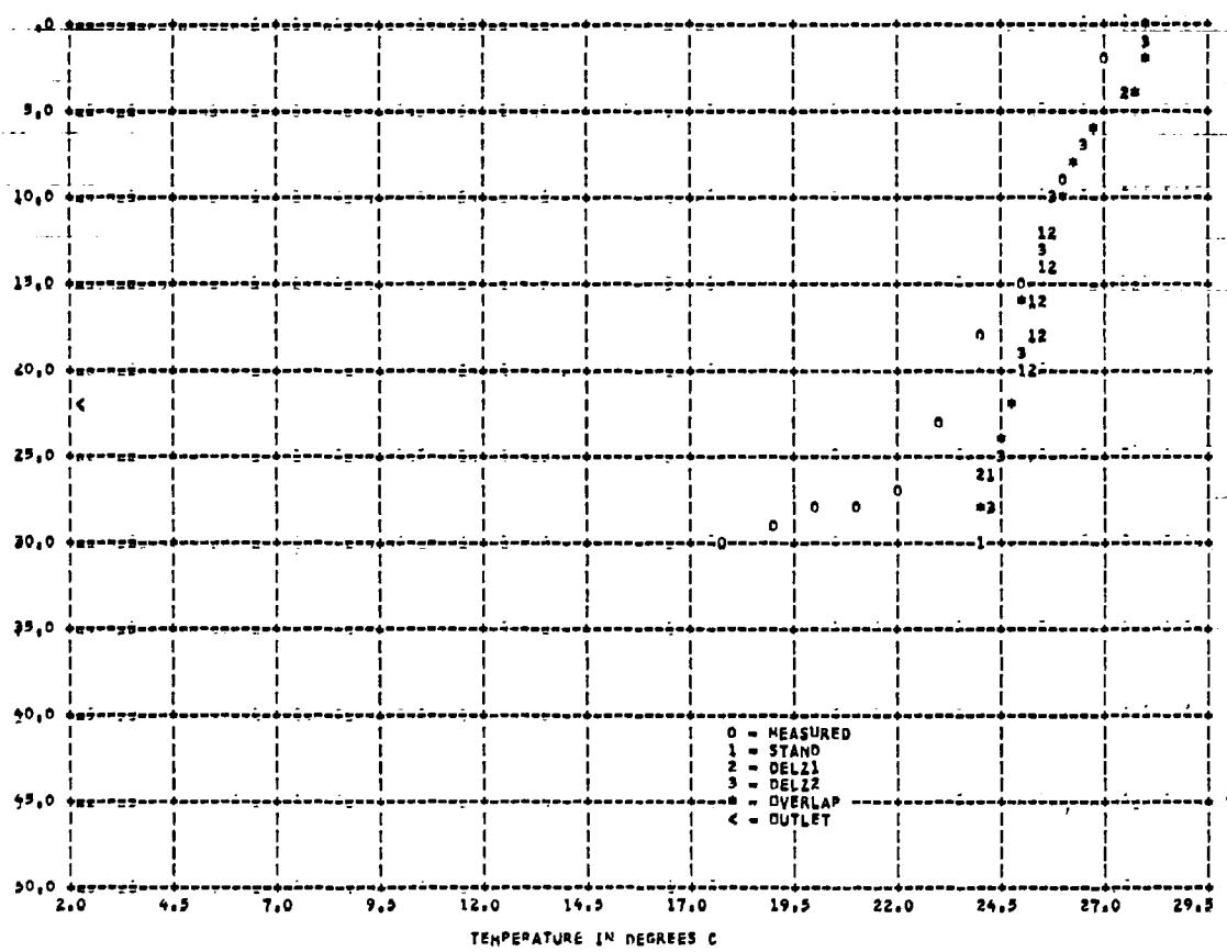
Figure 49 HIT MODEL \* DUGLAS RESERVOIR 1969--DAY 1250 --SURFACE ELEV 295.0 M
