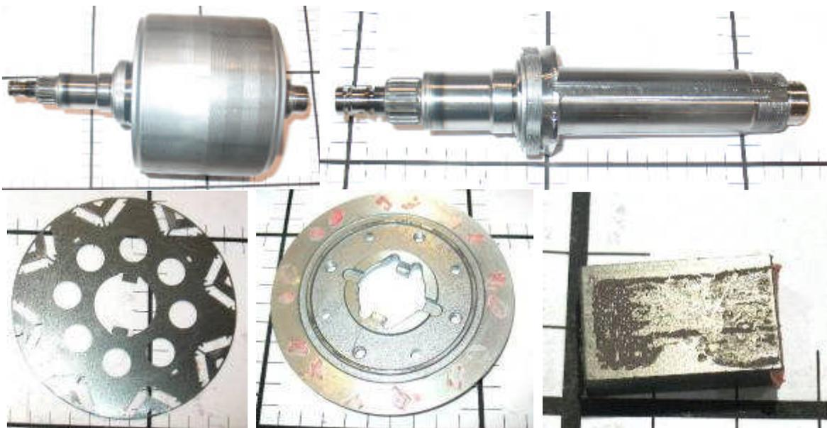
**Figure D-9: Generator Rotor Components**
